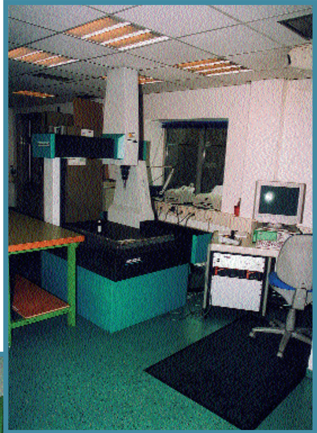
Eine von zwei CNC gesteuerten 3D-Koordinatenmeßmaschinen LH 65, Fabrikat WENZEL, Baujahr 1999.
