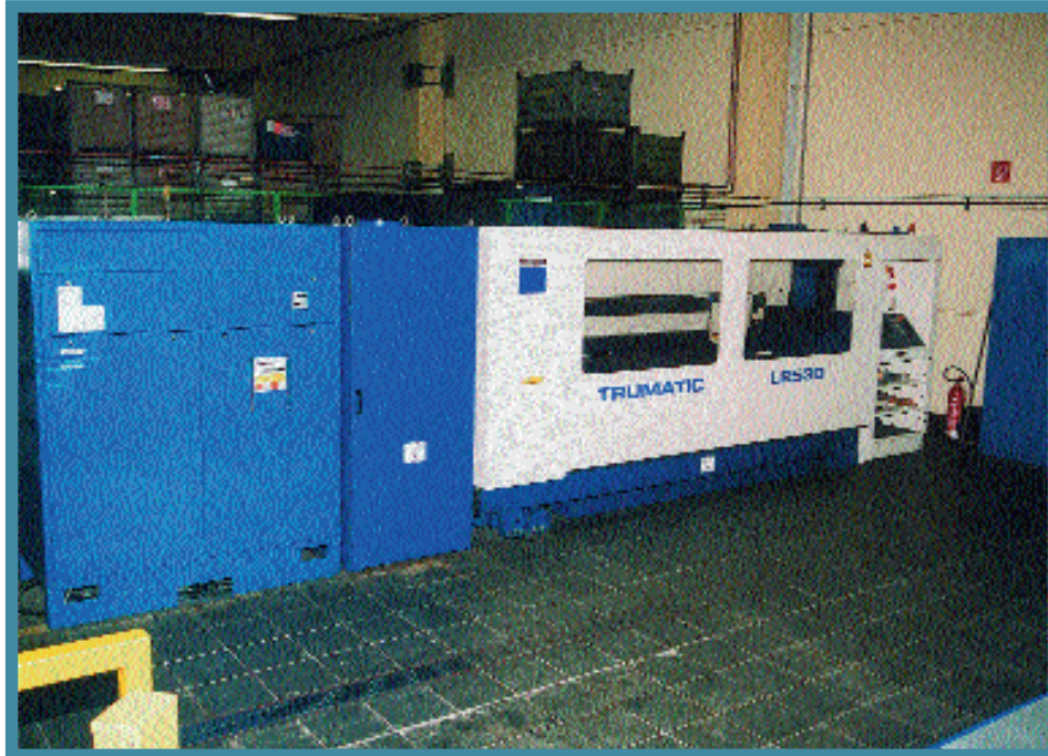
CO 2 -Laserschneidanlage TRUMATIC TC-L2530, Baujahr 1997.
