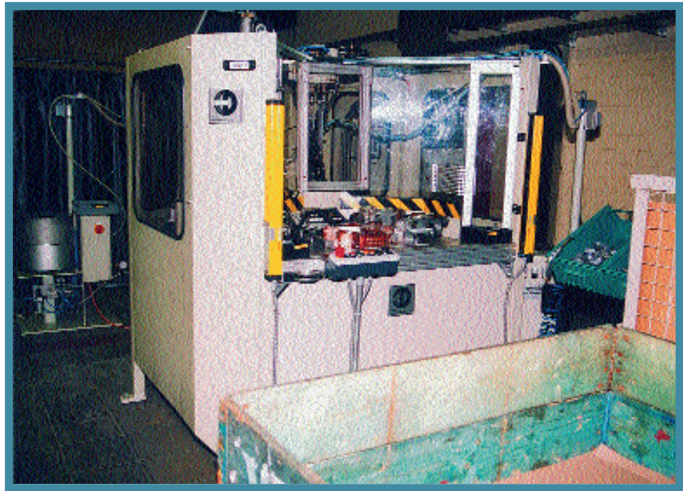
Punkt- und Buckelschweiß-Drehtischautomat J 180 ARW (Schweißleistung 130 KVA Mittelfrequenz), Baujahr 2000.
