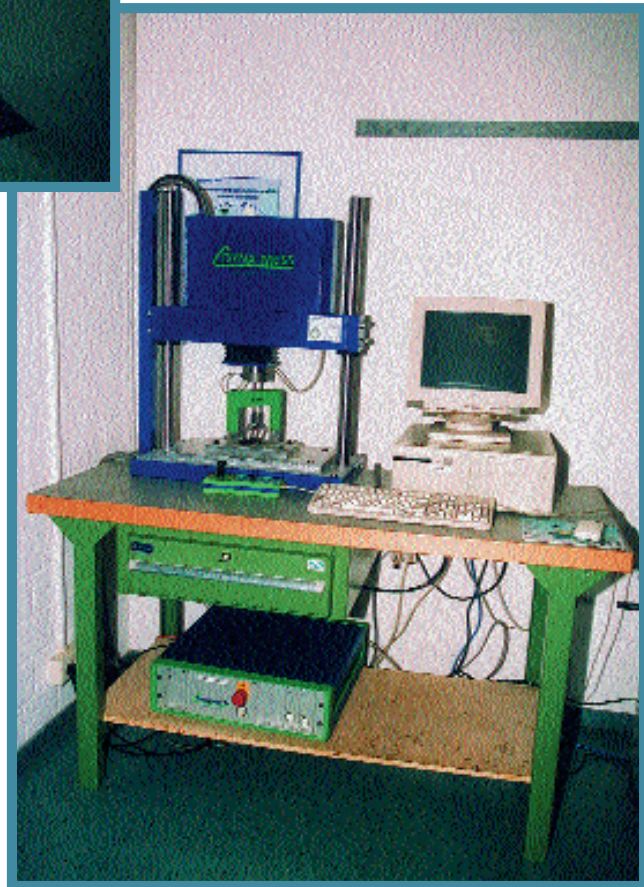
Prüfmaschine zur Durchführung von Ermüdungs- tests an Verbindungselementen (z.B. Schweißnähte und Nietverbindungen) Fabrikat DYNA-MESS.
